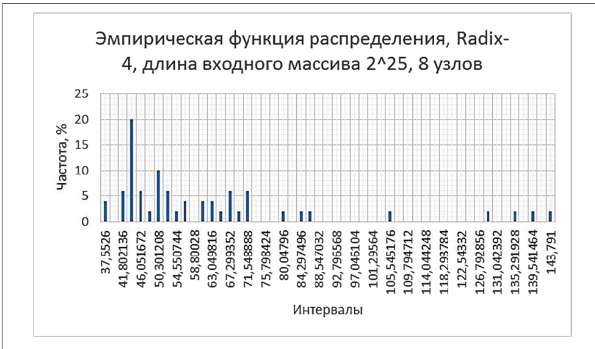
Рис. 5б. Функция распределения времени расчёта БПФ по алгоритму Radix-4 для набора случайных входных данных с длиной 2^{25} на 8 узлах кластера NWO5.
